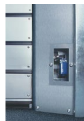
Предохранительные концевые выключатели встроены в боковые стойки
